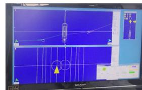
シミュレーション結果を正確に反映するため、船舶位置誘導システムにて投入作業を行う。
