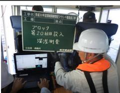
事前測量と同様に、測線間隔は、未測深部分が生じないように適切に設定する。
