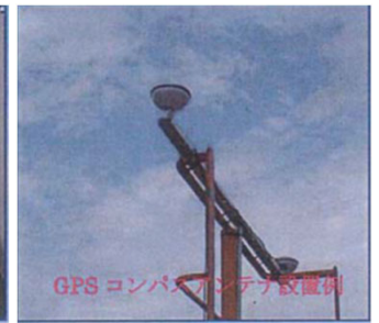
【GPSコンパスアンテナ設置例】
