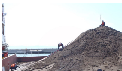
【人力による計測状況】
