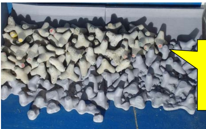
【3Dプリンタで再現した消波ブロックの現況】※写真は他現場
